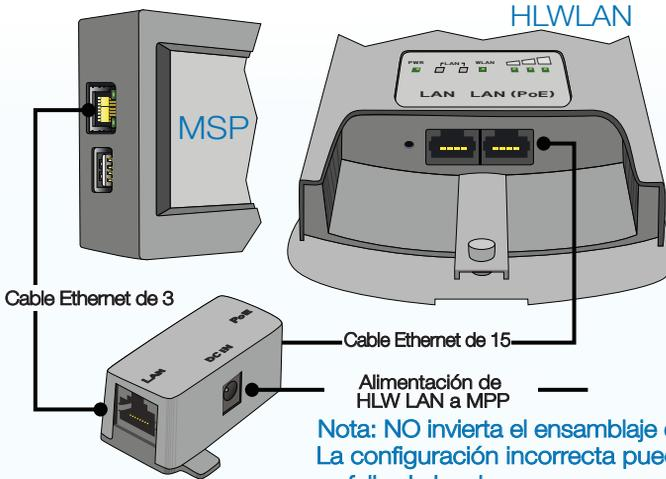
**Nota: NO invierta el ensamblaje de Ethernet. La configuración incorrecta puede provocar un fallo de hardware.**
